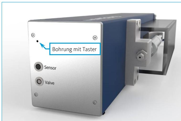
Halten Sie diesen Taster mit einem spitzen Gegenstand gedrückt. Damit wird das Modul bedienbar. Bauen Sie bei gedrücktem Taster mit einer kleinen Flussrate vorsichtig Druck auf, bis die Kupplung mit einem deutlichen “Klack” wieder einrastet.
