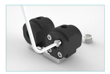
(3) Jetzt können Sie die Einlass-Gehäusehälfte mit der Flussdichtung abnehmen. Bei auf der Montageplatte montierten Ventilen kann es hilfreich sein, die Befestigungsschraube auf der Unterseite zu lösen, um Klemmen zu vermeiden.
