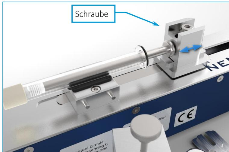
Befestigung der Spritze in der Kolbenaufnahme
